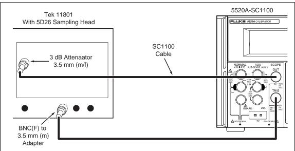
Figure 7. Edge Rise Time Verification Setup
